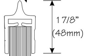
Sabot d'ancrage en 'L' en acier inoxydable (calibre 18)
